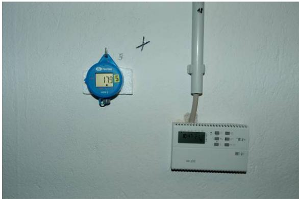
Andererseits wurde erkennbar, dass innerhalb des Magazinraums, in dem die Beheizung über einen Deckenlüfter erzielt wird, offensichtlich noch keine hinreichende Verteilung der Wärme über den gesamten Raum gewährleistet war. Um hier genauere Messergebnisse zu erzielen und daraus mögliche Maßnahmen zu einer besseren Verteilung
