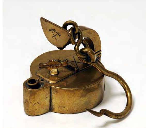
Abb. 79: Geschlossene Beamtenlampe für Ölbrand (Messingfrosch), Wilhelm Seippel, Bochum, um 1880, Vertrieb Gebr. Hilgenberg, Essen ( montan.dok/Museale Sammlungen 0300006895001 )
