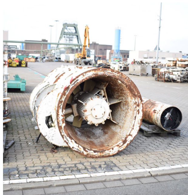
Der Lüfter gehört zu den Bauteilen der Teilschnittmaschine vom Typ AM 105, die im Skulpturenpark der Ausstellung „Das Zeitalter der Kohle. Eine europäische Geschichte“ zu sehen sein werden (Foto: Michael Ganzelewski)
