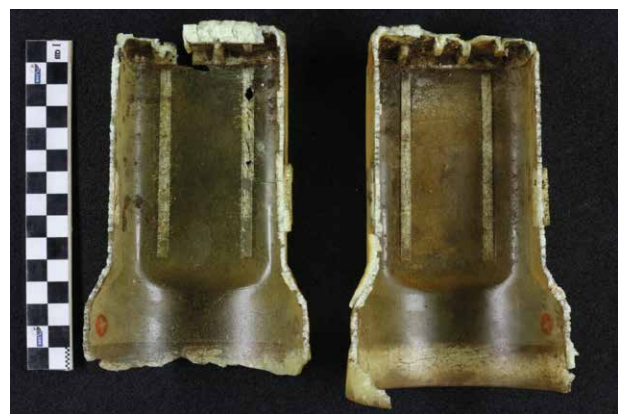
Typisches Erscheinungsbild für den stark fortgeschrittenen Zersetzungsprozess von Cellulosenitrat am Beispiel des Kunststoff-Einsatzes einer Gruben-Handlampe zur Aufnahme eines Akkus (Foto: Cristian Mazzon)
