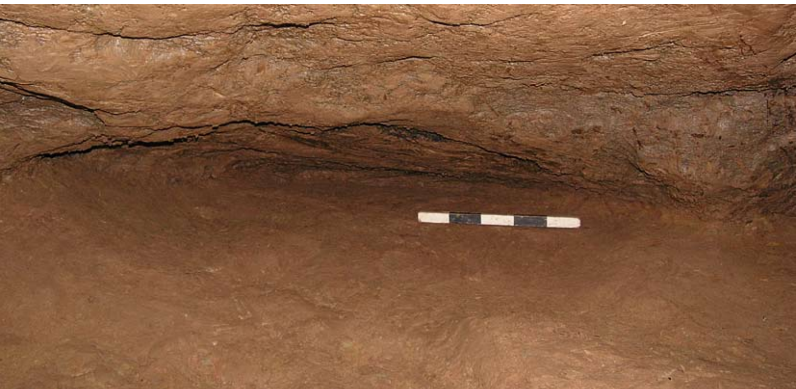
Abb. 15: Stollen Bruss, die halbrunden, sehr flachen „Ausläufer“ in Abbauraum 1 zeigen, dass die Bergleute der Erzlage soweit wie irgend möglich folgten
