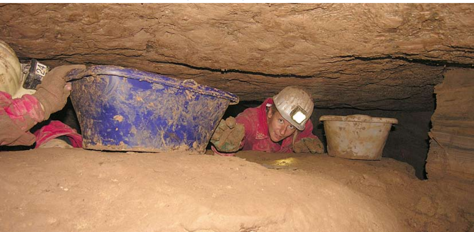
Abb. 17: Stollen Bruss, in den flachen Abbaubereichen erfolgte der Abbau im Liegen
