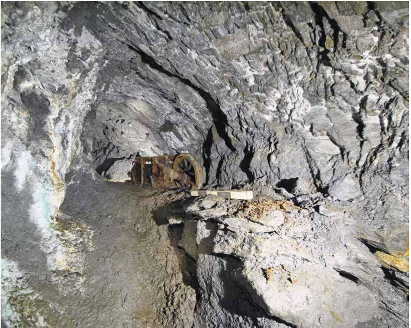
Abb. 20: Grube Landeskrone: Kleine Bühne des Nachlesebergbaus im Liebfrauentgang. Die Schubkarre in der Bildmitte wurde bis zum Ende der Bühne gefahren und dann in die linke Bildhälfte ausgekippt. (© Foto: LWL-Archäologie für Westfalen/M. Zeiler)
