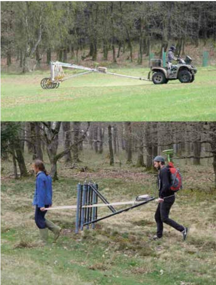
Abb. 3: Magnetometerprospektion auf dem Montanareal Ratzenscheid 2017 durch das Ludwig Boltzmann Institut Wien mit am Quad angehängter Sondenkonstruktion im leichten Messgelände (oben) sowie Sondentragegestell im Bereich schwierigerem Messgeländes. (© Fotos: Verein für Steierländer Bergbau e.V./C. Weber)
