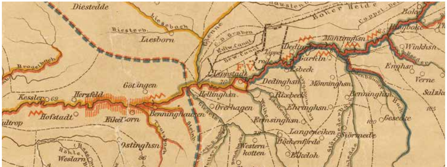
Abb. 3: Ausschnitt der „Fluss- und Fischerei-Karte der Provinz Westfalen“ zum Flussgebiet der Lippe, von der kgl. Meliorations-Bauinspektion in Münster 1889 veröffentlicht. Die Karte gibt neben den Wehren auch die Standorte der Fischwege und Aalleitern an, die Wasserkraftbetreiber entlang der Hauptströme betrieben. Es ist anzunehmen, dass die an kleinen Zuflüssen installierten Fischwege nicht systematisch erfasst wurden. Zumindest verweisen technische Schriften dieser Jahre immer wieder auf Konstruktionen abseits der Hauptflüsse, die die Fischerei-Karten nicht verzeichneten. (Kgl. Meliorations-Bauinspektion, Münster (Bearb.): Fluss- und Fischerei-Karte der Provinz Westfalen. Landesarchiv NRW – Abteilung Westfalen – LAV NRW W, W 051/Kartensammlung A, Nr. 15371)
