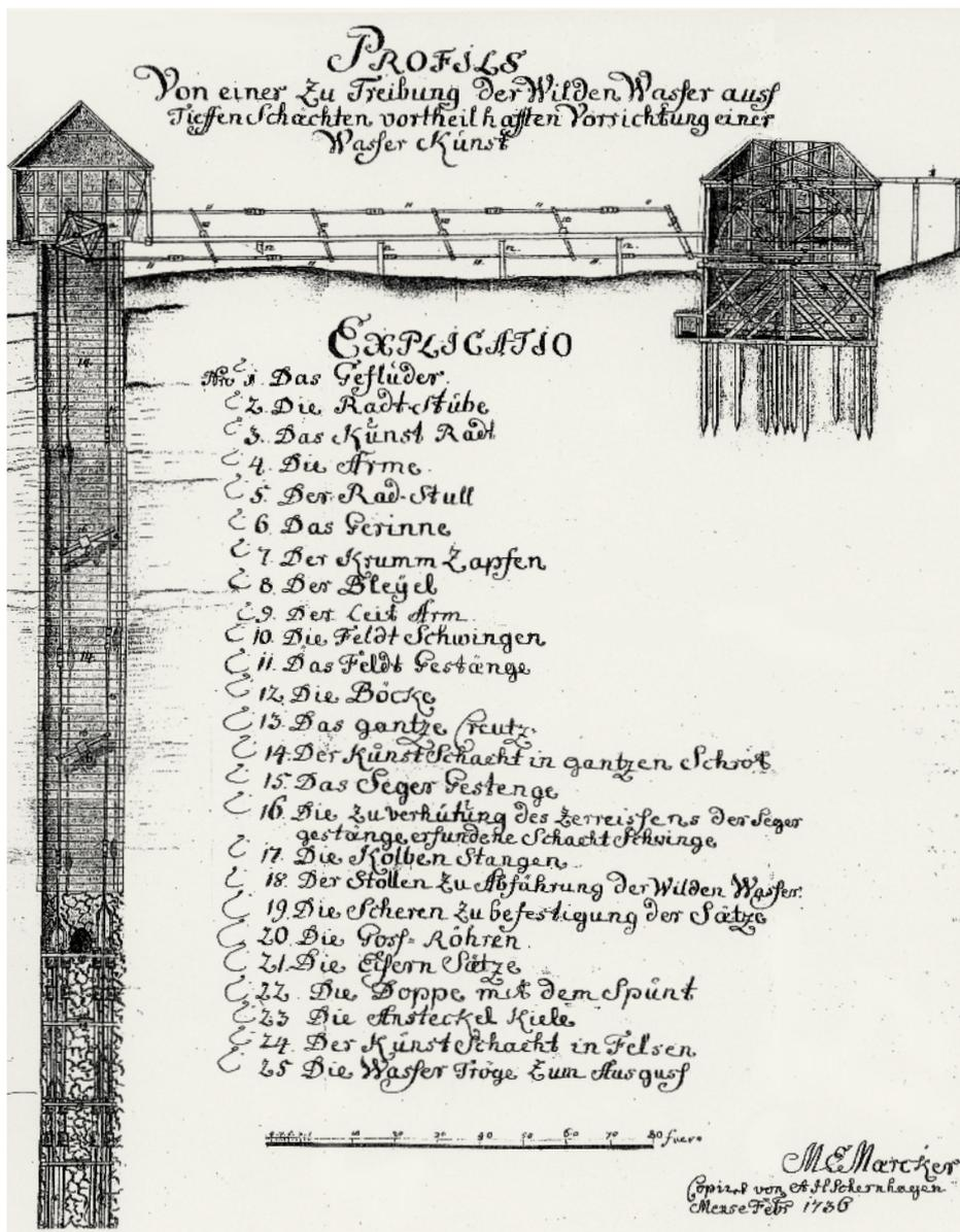
Abb. 4: Profilriss einer Kunst des Krummen Zapfens (Stangenkunst mit Kunstkreuz) als vorteilhafte Wasserkunst vom Geflüder (1), dem Krummen Zapfen (7), dem Feldgestänge (11) bis zu den Gussröhren (20). Zeichnung des Markscheiders und Bergmeisters M. E. Maercker, 1736. (© Foto: NLA HStA BaCI)
