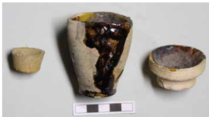
Abb. 13: Gefäße, die beim Probiervorgang Verwendung finden (v.l.n.r.: Aschkupelle, kleiner Dreieckstiegel und Ansiedescherben), aus der Verfüllung eines technischen Ofens im Kreuzgang des Annaberger Franziskanerklosters. (© LfA Sachsen, S. Bock)
