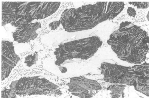
Abb. 7: Gefügebild von untereutektischem Roheisen aus Metzingen-Kurleschau (REM-Bild, geätzt mit 3%iger Salpetersäure).
